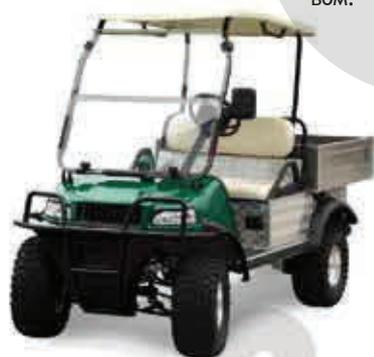
Модель Express Work обладает впечатляющей грузоподъемностью 580 кг и оснащена усиленным опрокидывающимся кузовом.
