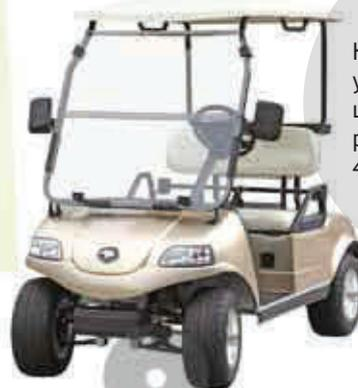
Наш стандартный гольф кар уже в базовой комплектации оснащен электромотором 48 вольт мощностью 4 л.с..
